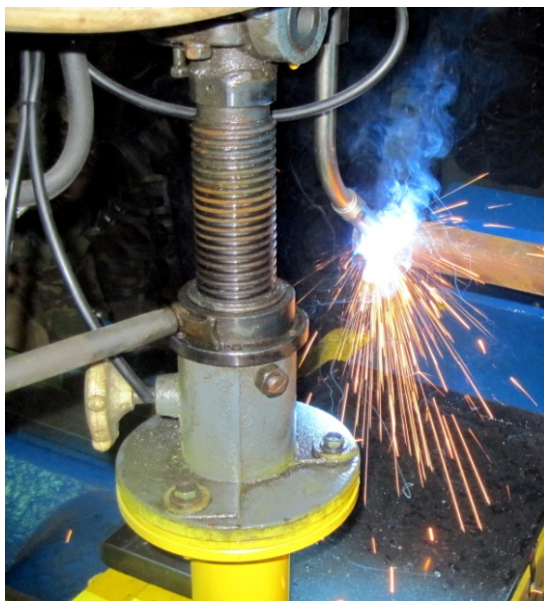
Рис. 2. Вибродуговая наплавка вала
